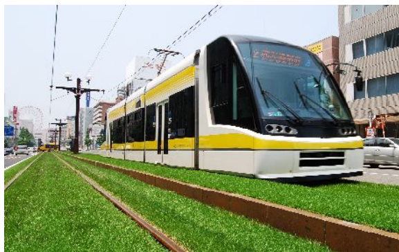
↑市電センターポール&軌道敷緑化
